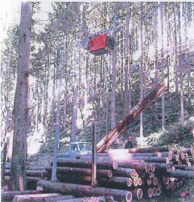
2021, 11 熊地内にて 架線集材 (主索ワイヤーを張り、ラジキャリアで) 搬出路を開設しないで、沢越しに市道横へ集材。 架線は扇型に3方向へ張り替えている。
