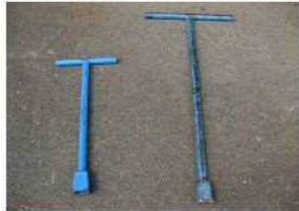
消火栓を開閉する道具
