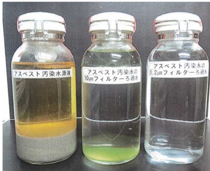
写真10 処理水等の外観
