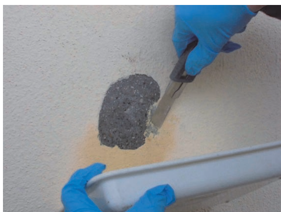
カッターナイフでの試料採取状況
