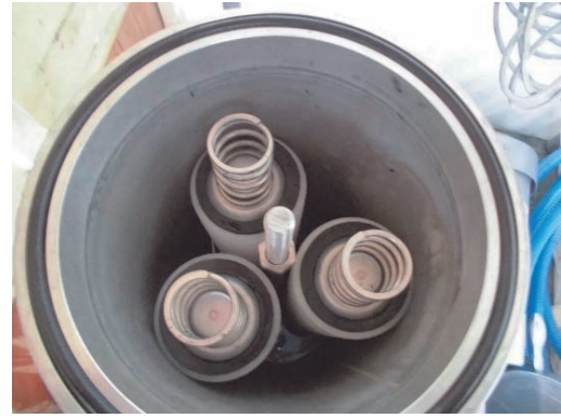
写真8 膜ろ過フィルターの支持部
