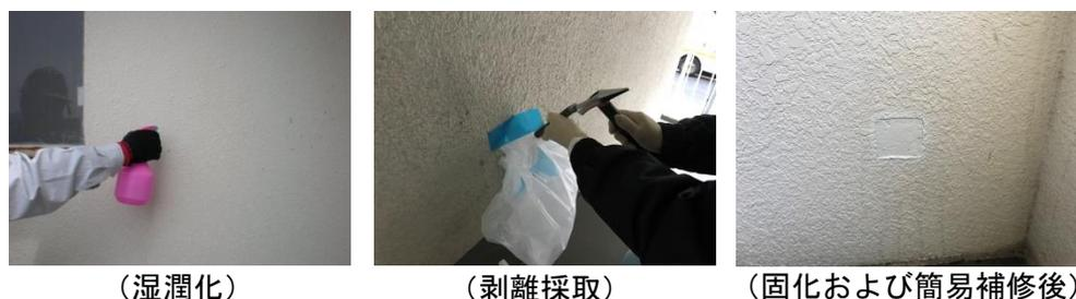
図－6 サンプルング例（建築用仕上塗材等）
