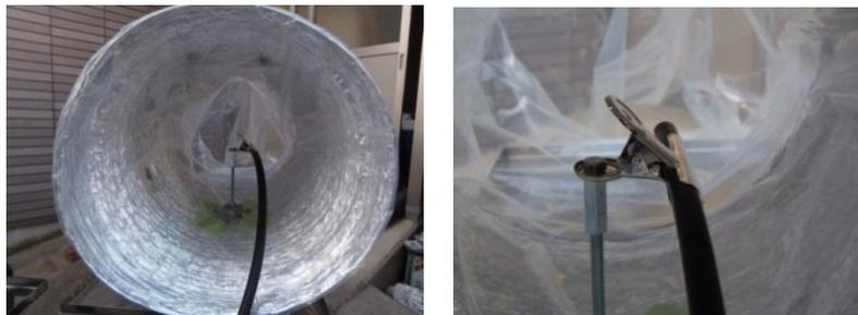
図-38 チューブ配管を使用した場合の排気ダクトの測定例
