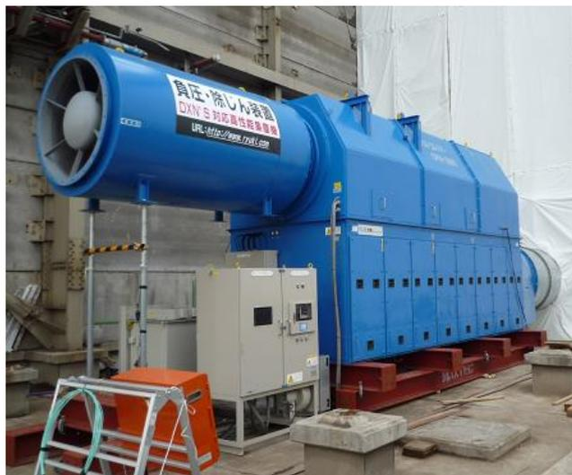
写真X-1 大型集じん・排気装置の例（定格風量1,800m<sup>3</sup>/分）
