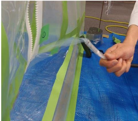
図-31 スモークテスターによる確認
