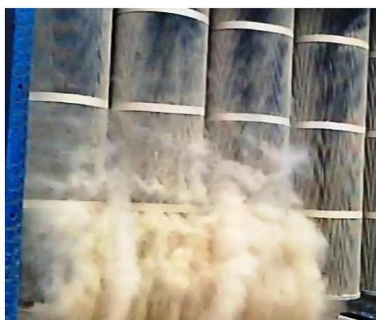
写真X-2 プリーツ成形フィルタの例
