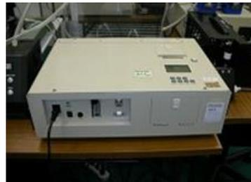
図-36 繊維状粒子自動計測器の例
