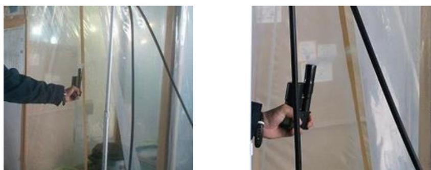
図-29 セキュリティーゾーンの入口の気流方向の確認
