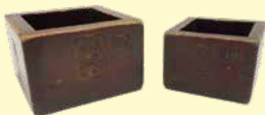
液用一合枡と五勺枡 一合(約 180 mL)と五勺(約 90 mL)を量る枡。
