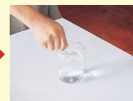
③チューブをおさえたままピンをぬいた穴の方を水に入れゆっくり水を吸いこむ。
