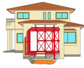
耐震シェルター「レスキュールーム」 (仕上げ工程前)
