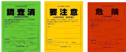
応急危険度判定により家に張り出されるステッカー （出典:応急危険度判定協議会ホームページ）
