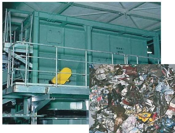
磁性物の選別機と回収された鉄類
