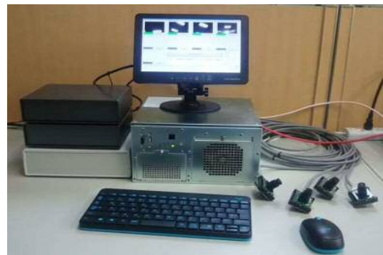
【CVC IoTロガーでカメラ画像を取り込みしている様子】
