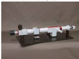
高出力レーザのFFP(ファーフールドパターン:放射角度分布特性)計測用の光学系
