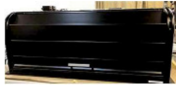
光散乱測定器『S-Finder』概観 幅1000mm×奥行き600mm×高さ400mm
