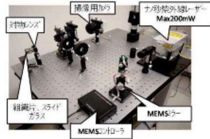
PC上でスライドガラスの組織片画像を見ながら切り出す部分をマウスで描画。描画部分に沿って高速にレーザーを照射し、その部分を切り出すことができる。
