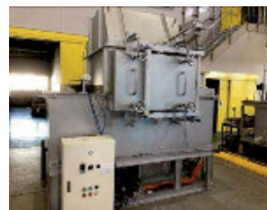
■溶解保持炉外観 重量約1.82tonであり、従来の溶解保持炉に比べて非常に小型かつ軽量である。
