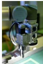
↑先端部に設置したカメラで部品の位置を認識して、ハンドで取り上げる
