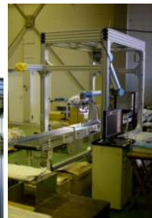
↑右側奥からベルトコンベア上の流れてくる部品をロボットが取り上げる。ロボットを吊り下げることにより、小スペースを実現している
