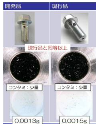
↑【開発品と現行品との違い】それぞれ締結しても、発生するコンタミ(夾雑物)の量は、ほぼ同じです
