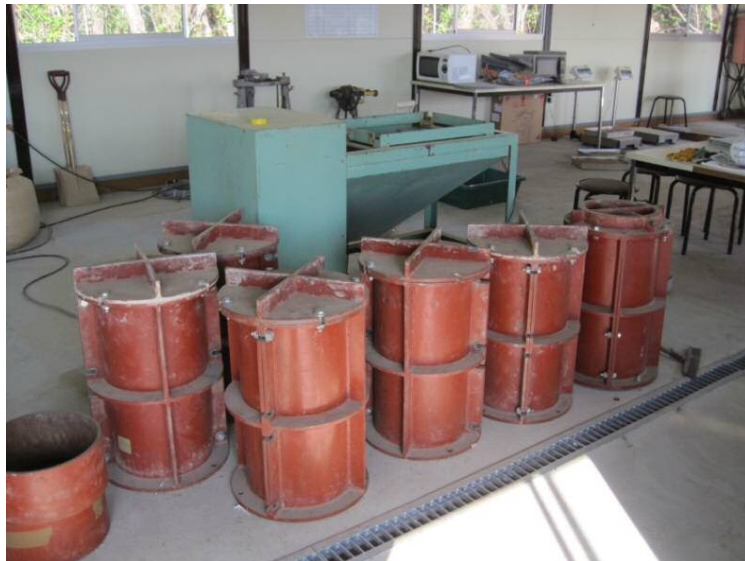
大型供試体型枠
