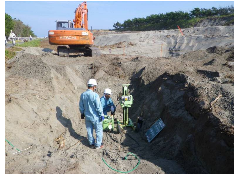
SW式サウンディング試験
