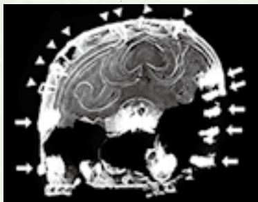
①X線写真 修理で打ち込まれた金の釘(△印)と銀の釘(▽印)が鮮明です。
