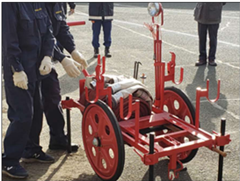
可搬ポンプを下した荷台部分
