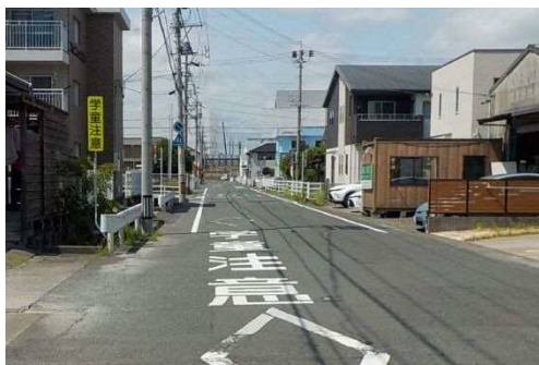
[路面表示と注意喚起看板を設置した例]
