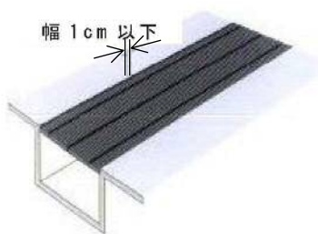
[グレーチング蓋 (細目ノンスリップ) 参考図]
