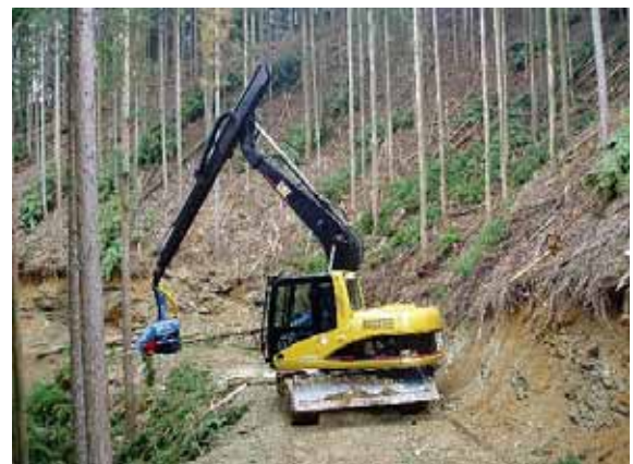
ハーベスタ（伐木造材機）による間伐・択伐
