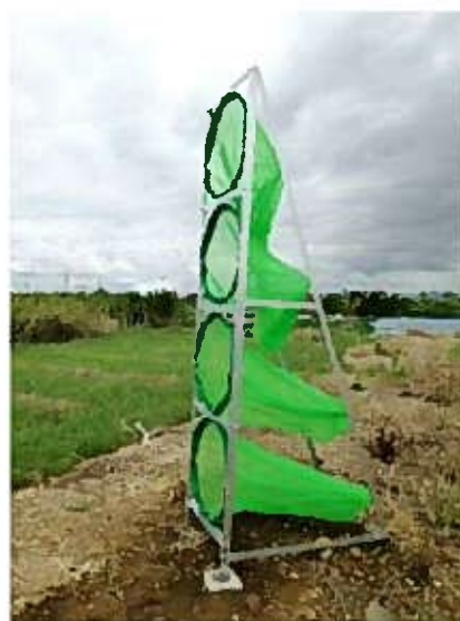
砂採取実験装置、野球場予定地設置状況
