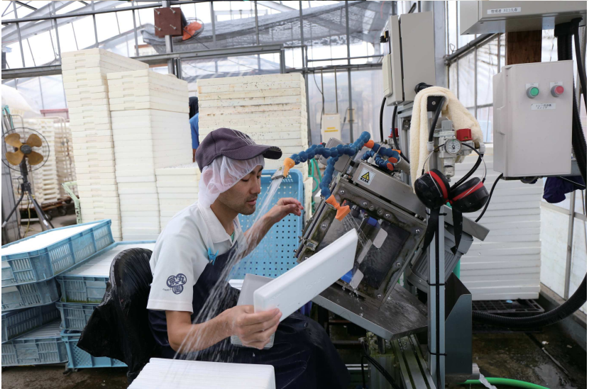
上：中にブラシを備えトレーを入れることで洗淨できるよう製作した機械
