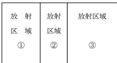
隣接する放射区域のうち、①+②と②+③とを比較し、隣接する大なる方を消火剤の貯蔵量とすることができる。
