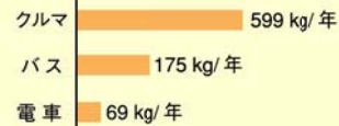
交通手段別の年あたりCO 2 排出量 (一日に10km移動する場合)
