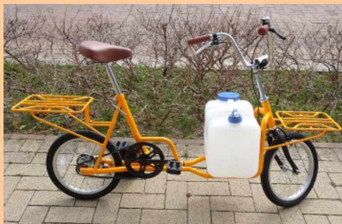
図 45 給水タンク運搬に重点を置いたデザインの試作車
