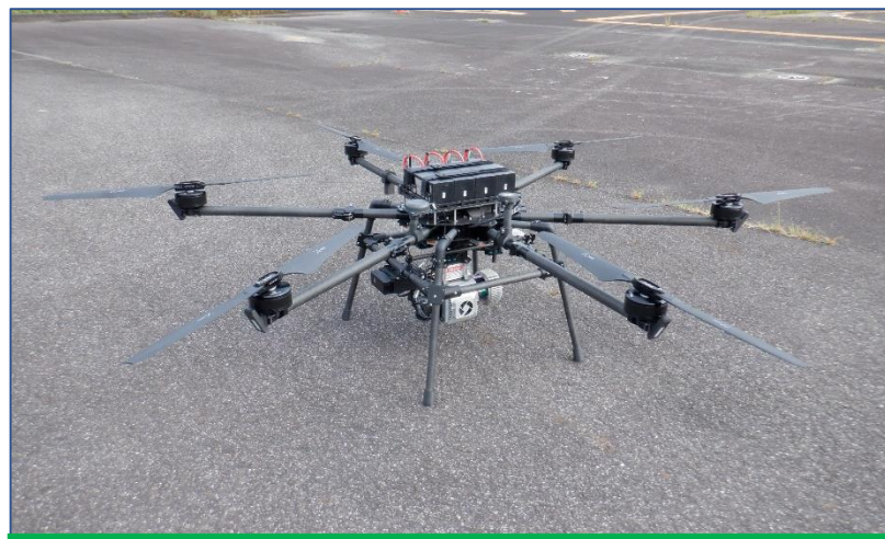
レーザ測量ドローン
