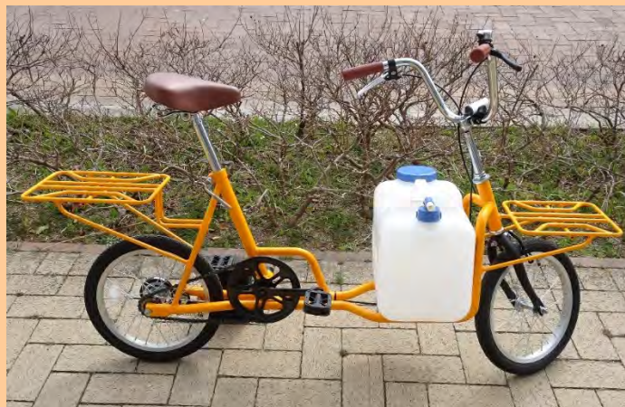
図 45 給水タンク運搬に重点を置いたデザインの試作車
