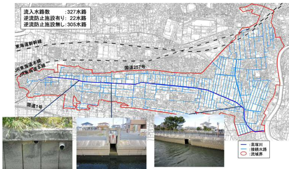
接続水路の状況
