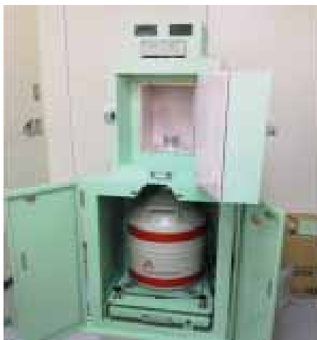
図-1 ゲルマニウム半導体検出器 （キャンベラ社製）GC2020
