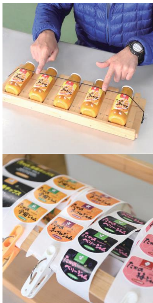
左：高所での作業や、細かい作業を必要とするみかん果実の二度切り（実から出た茎を根元で切る作業）も難しくこなす。 右：従業員みんなで考えて製作した、ラベル貼りのための治具。ジュースやジャムなどのボトルへのラベル貼りを均一に、効率よく行うことができる。
