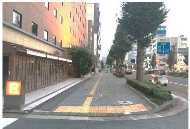
無電柱化による地震時の倒壊防止
